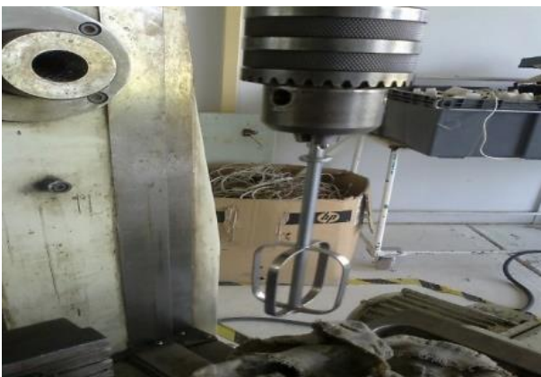
Figura 2 Agitador mecánico habilitado para el mezclado
